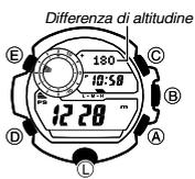
La schermata del modo di altimetro dispone di un valore di differenza di altitudine che mostra il cambiamento di altitudine da un punto di riferimento specificato dall'utilizzatore. Il valore della differenza di altitudine viene aggiornato ogni volta che l'orologio ottiene una lettura di altitudine.
