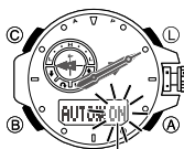
Indicateur de commutateur d'éclairage automatique en service
